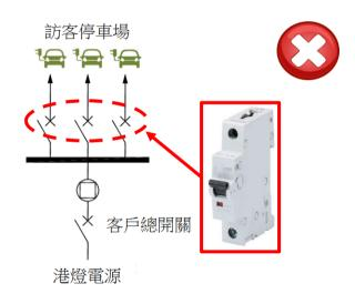
每個最終電路不可沒有對地漏電保護的保 護器件。
