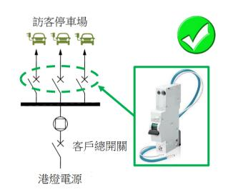
每個最終電路應有一個餘差啓動電流值 不超過 30 毫安的對地漏電保護器件作保 護。
